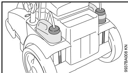
Уровень заправки каждого резервуара может считать через въемки в корпусе.
